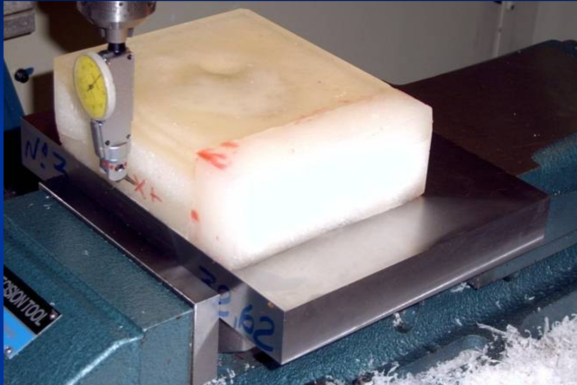
Fig. 4.11 – Bloco colado na base retificada. O relógio comparador permitiu que o bloco fosse corretamente reposicionado.
