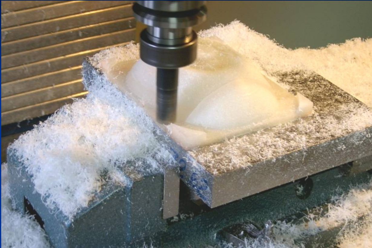
Fig. 5.20 – Usinagem para fim do acabamento e separação da possível prótese.
