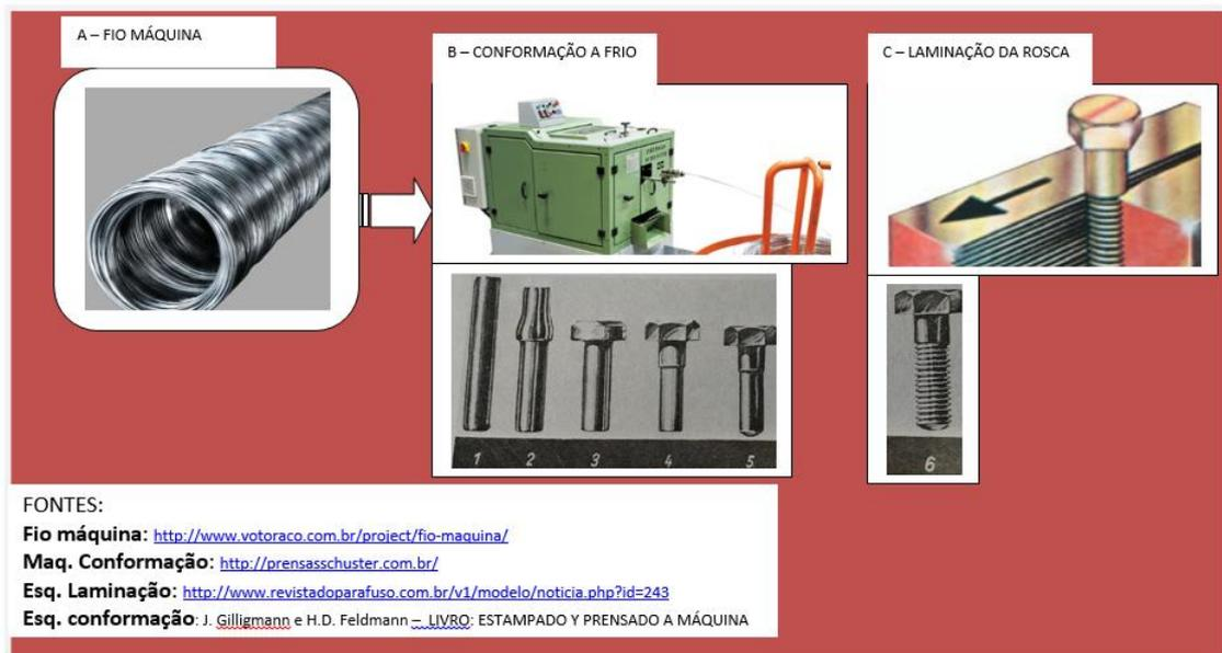
Figura 2 – Manufatura discreta – fabricação de parafusos
