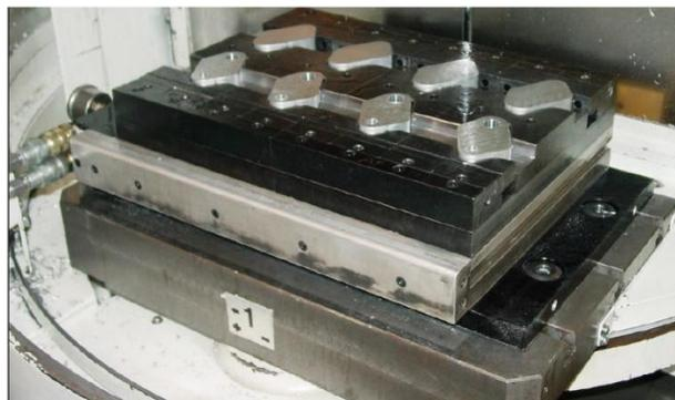
Figura 17 - dispositivo de fixação modular com acionamento hidráulico. Fonte: <http://pawsholding.com/>
