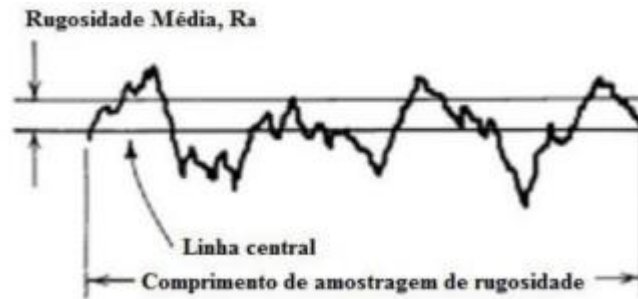
FIGURA 5 - ESQUEMA REPRESENTATIVO DA RUGOSIDADE MÉDIA
