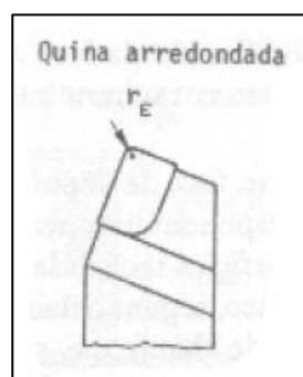
Figura 2 - Quina Arredondada com raio de ponta r_e Fonte: Stemmer, Ferramentas de Corte I 3ª Ed
