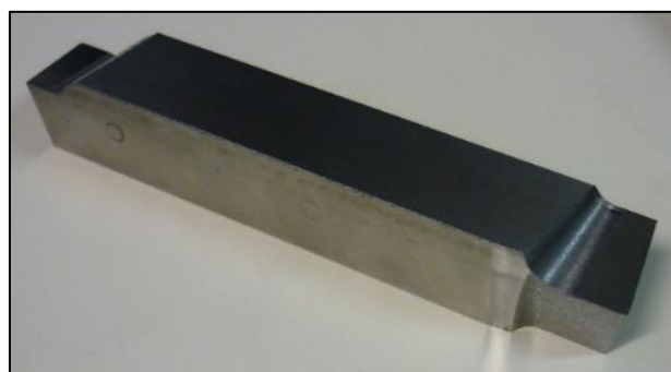
Figura 8 - Ferramenta tipo Bits, com dois lados de corte.
