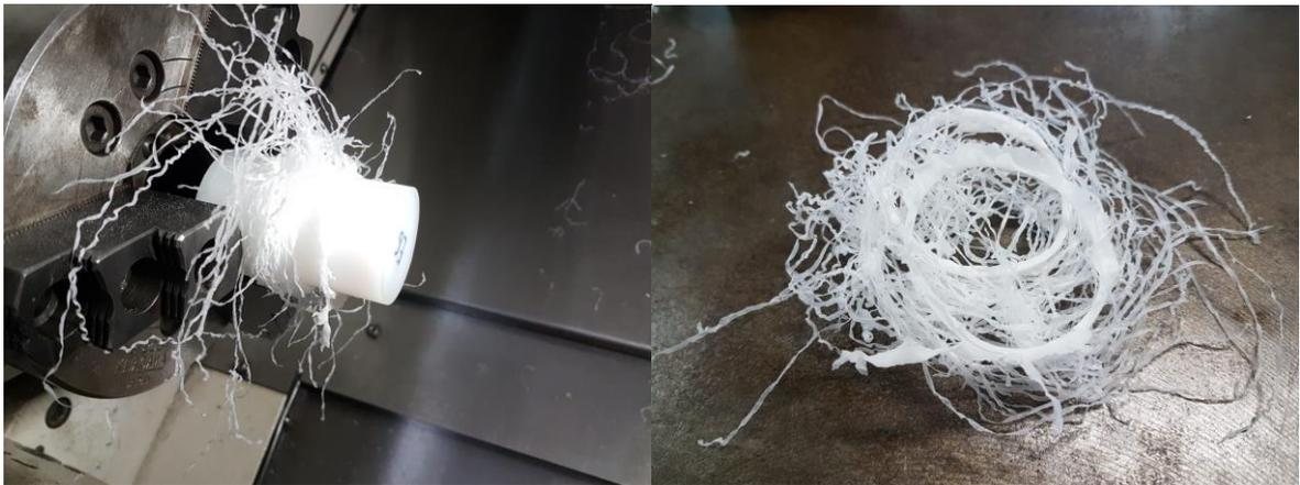
(G74;  $V_c = 250\text{m/min}$ ;  $F = 0,10\text{mm/rot}$ ;  $A_p = 1,25\text{mm}$ ;  $\text{Recuo} = 0,1\text{mm}$ )
