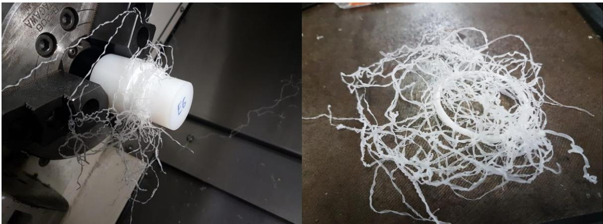
*(G74;  $V_c = 250\text{m/min}$ ;  $F = 0,10\text{mm/rot}$ ;  $A_p = 1,25\text{mm}$ ;  $\text{Recuo} = 2\text{mm}$ )*
