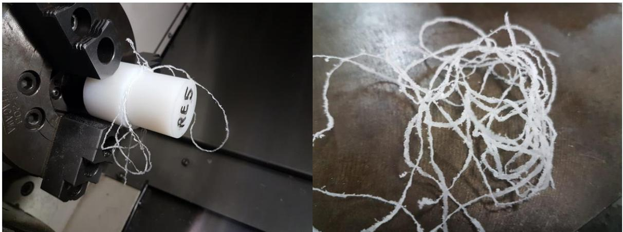
*(Acabamento;  $V_c = 250\text{m/min}$ ;  $F = 0,10\text{mm/rot}$ ;  $A_p = 0,1\text{mm}$ )*
