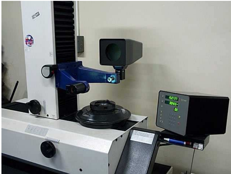
Figura 3 – Máquina de medir ferramentas - Presetter
