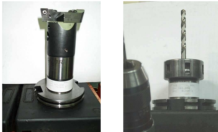
Figura 4 – Etiquetas adesivas indicando as dimensões das ferramentas
