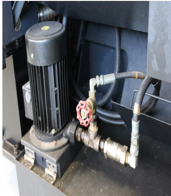
Unidade de arrefecimento (fluido de corte)
